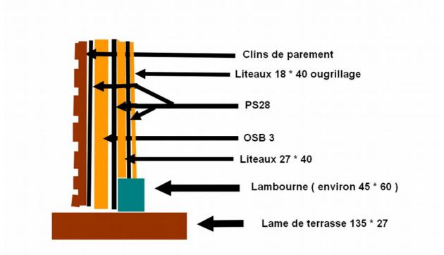
Si situation contre un mur, un simple rideau anti-réverbération en PS 28 suffira, il n'y aura qu'une lambourne fixée au mur pour supporter le panneau de toit
