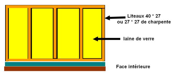
Mettre le seconde couche de PS 28, face rugueuse visible et la fixer avec des liteaux 18 \* 40 ou 27 \* 40 ou du grillage à mailles soudées
